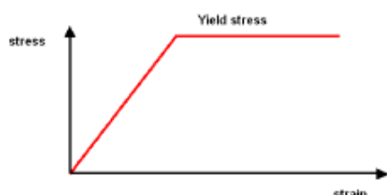
شکل 6: منحنی تنش کرنش مواد الاستیک-کاملاً
